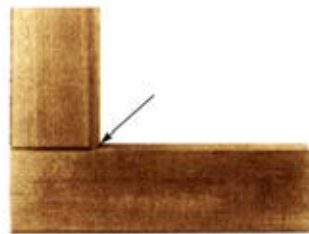
Construction correcte, dans laquelle la tête du montant est protégée, réduisant ainsi les risques d'absorption d'humidité.
