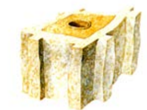
La même cellule du bois placée dans un environnement à forte humidité.
