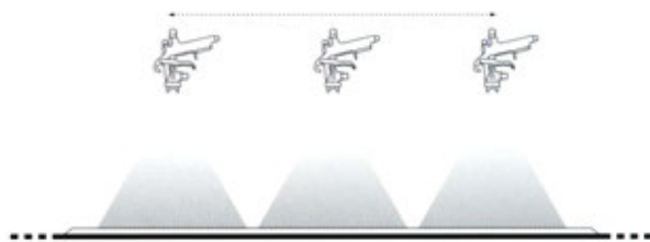
Pintura de una superficie plana. Manteniendo la pistola paralela a la superficie, se obtiene una capa de espesor uniforme.
