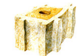
La misma célula de la madera situada en un ambiente con alta humedad
